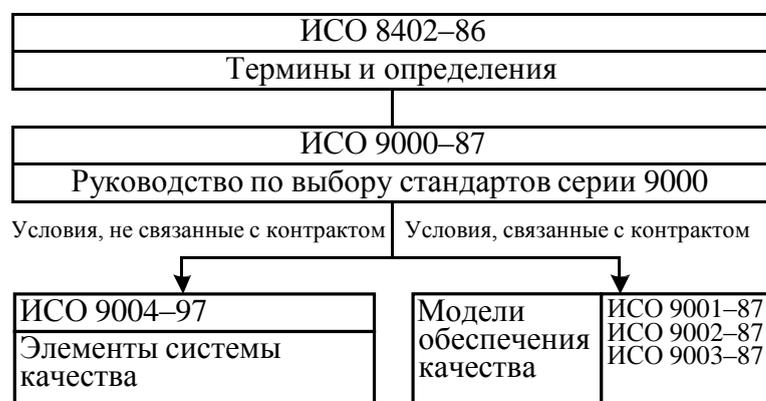
Рис. 6.3. Структура комплекса МС ИСО серии 9000
